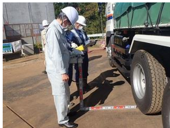
輸送車両の空間線量率測定
