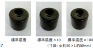
図4 ガラス試験片の均質性評価 (目視観察) (寸法: φ約50 × L約50mm)
