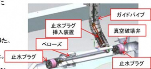
真空破壊ラインの止水プラグ施工図
