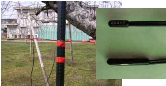
図1 センサーの設置方法(右枠内の上:T&D・TR-0106、下:CHINO・MR9301M05)
