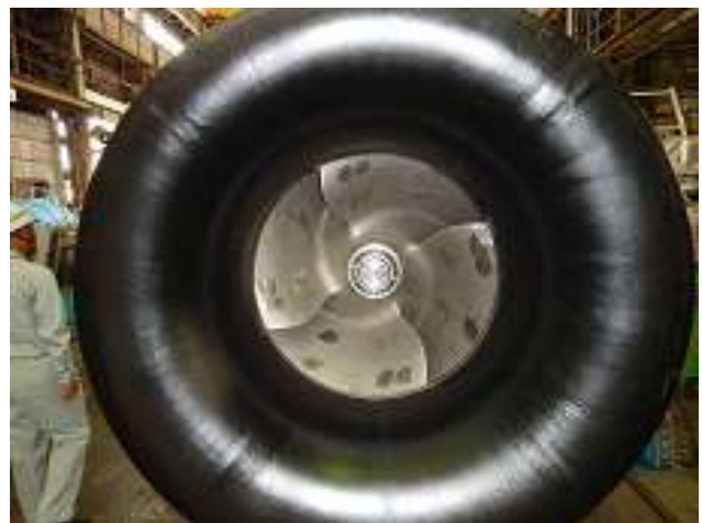
\phi 1000\text{mm} 排水ポンプの吸込口
