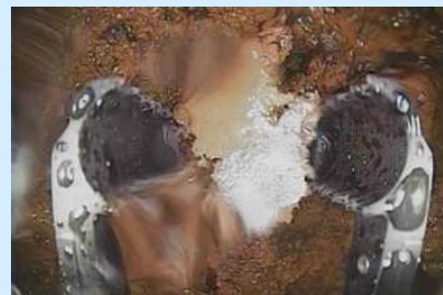
ペDESTAL内堆積物の把持状況
