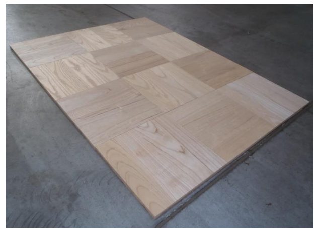
図4 クロスパネルのコンクリート床への設置
