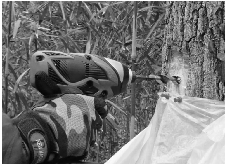
図1 木工用電動ドリルを用いた試料の採取
