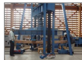
《オープンラボラトリーの 利用風景(実大曲げ試験)》
