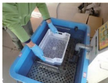
温湯処理機（タイガーカワシマ社：湯芽工房YS-200L）による温湯浸漬処理の様子
