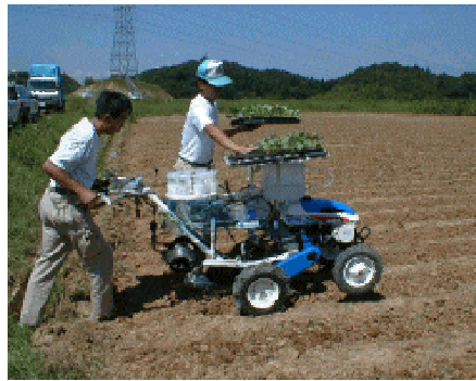
図 1 セル苗定植機の作業状況（機械操作、機械補助（苗補給）の2名組作業）
