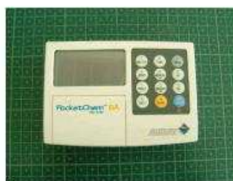
図2 携帯型血中アンモニア測定器
