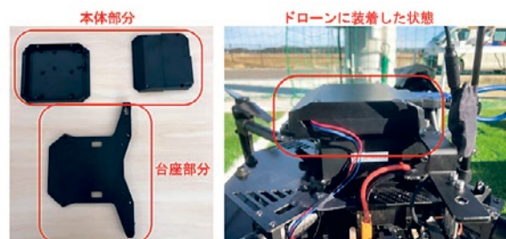
異なるフライトコントローラを制御するシステムを格納したコントロールユニット
