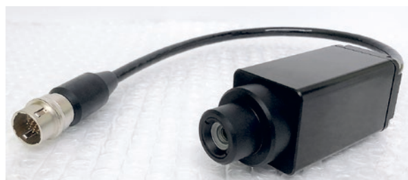
【寸法】34mm×34mm×100mm 【重量】200 g 以下 【解像度】JAXA と共同開発した 50 万画素の耐放射線撮像素子を採用 【耐放射線性】2MGy 以上
