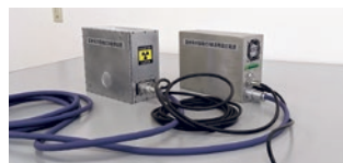
今後搭載予定の冷陰極式 X 線源装置
