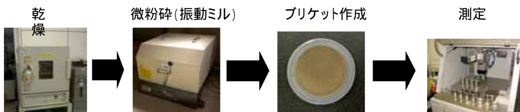
図1 エネルギー分散型蛍光X線分析装置による堆肥中元素定量の流れ
