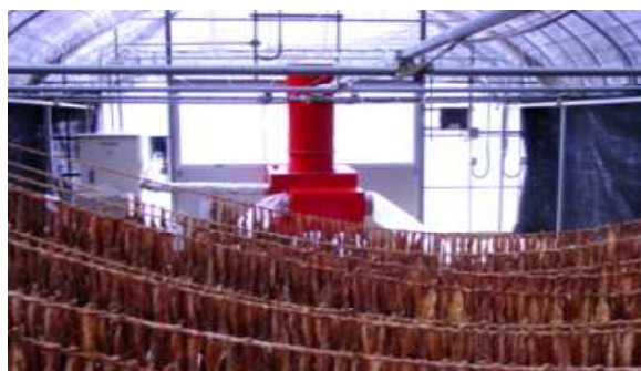
写真1 移動式簡易温湿度制御乾燥装置
