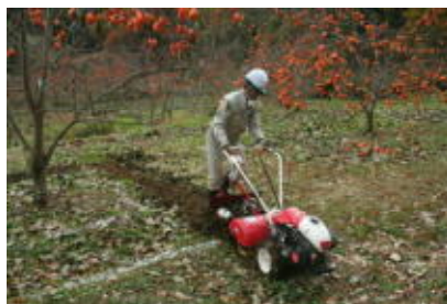
図2 機械による剥土の様子
