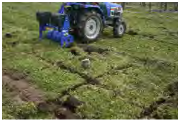
図1 ソッドスライサー装着 トラクターによる剥土作業
