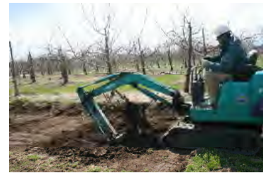
図3 小型バックホーのバケットを 利用した抜根作業
