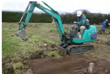
図2 小型バックホーの排土 板を利用した集土作業
