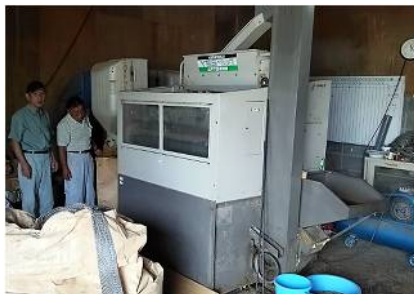
写真1 大豆ベルト式選別機(山本製作所製)
