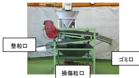
写真2 モータ振動網式ナタネ選別機(試作機)
