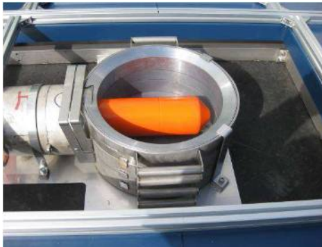
図1 可搬型測定器による測定（左：検出器と遮蔽体、右：牧草ロール測定）
