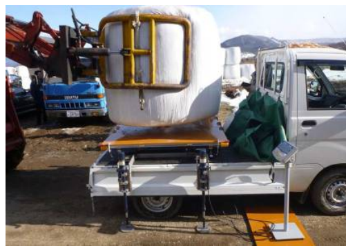
図1 可搬型測定器による測定（左：検出器と遮蔽体、右：牧草ロール測定）
