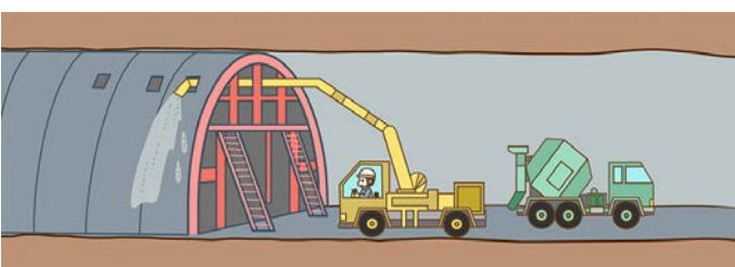
コンクリート覆工 (ふっこう) 防水シート内側にセントル(鋼製の半円筒形の型枠)を設置し、すき間にコンクリートを充填します。コンクリートが固まったらセントルを外して完成です！
