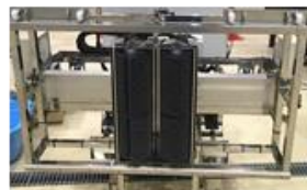
壁面除染装置
