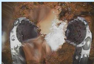
ペDESTAL※ 3 内堆積物の把持状況
