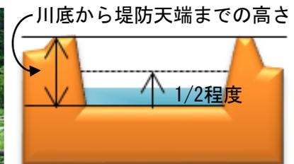
※危機管理型水位計は、河川水位が川底から堤防天端までの高さの1/2程度を超えた際に観測を開始する水位計です。
