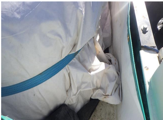
シートの差し込み、固縛
