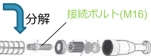
セグメントとスクリーボルト継手(接続部)
