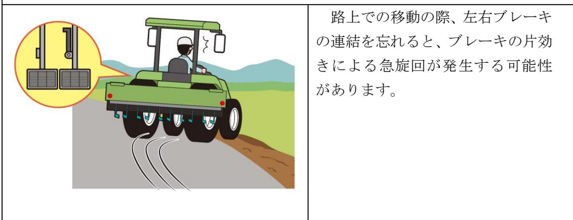
図2 乗用型トラクターの片ブレーキ
