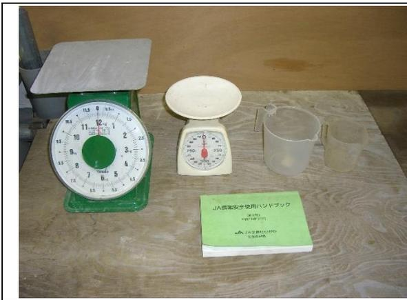
正確に農薬を計量できるように、計量機器を用意します。計量する場所は水平に保ちます。
