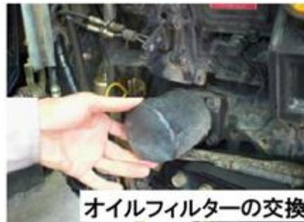
図3 エンジンの保守点検の例（トラクター、コンバイン等）
