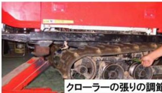
図4 走行部の保守点検の例（トラクター、コンバイン等）
