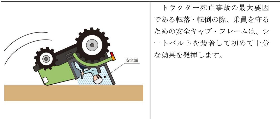
トラクター死亡事故の最大要因である転落・転倒の際、乗員を守るための安全キャブ・フレームは、シートベルトを装着して初めて十分な効果を発揮します。
