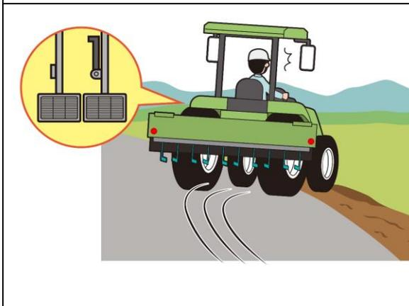
路上での移動の際、左右ブレーキの連結を忘れると、ブレーキの片効きによる急旋回が発生する可能性があります。
