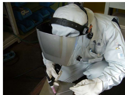
ステンレス（SUS304）材の突合せ溶接
