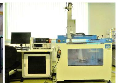
超音波探傷映像化装置
