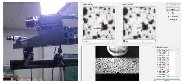
非接触ひずみ測定システム
