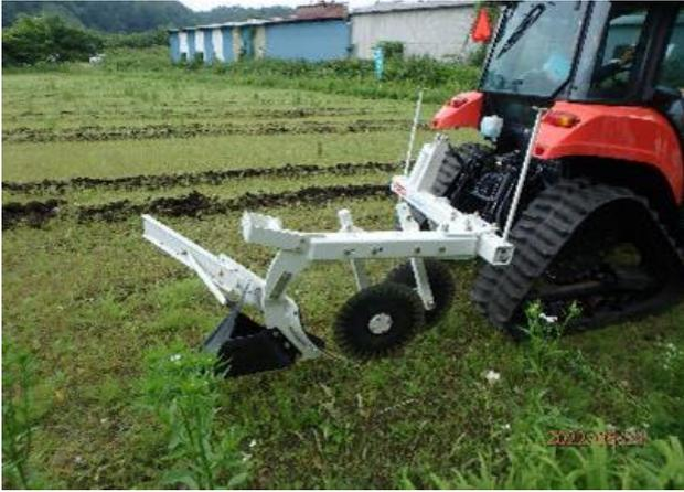
写真1 トラクタ(70Ps)に装着した溝切り機
