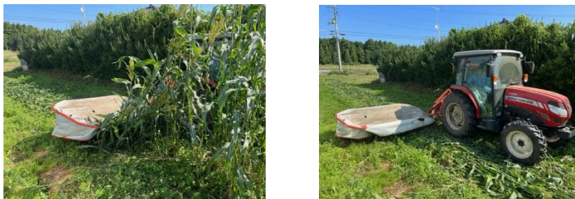
図3 ディスクモアによるソルガム収穫(収穫(左)作業機(トラクタ装着時(右)))
