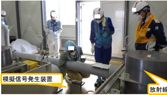
(写真 2 - 1) 放射線モニタ (A) の「校正検査」 の状況① (模擬信号入力) の状況
