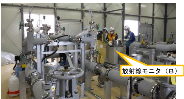
(写真 3) 放射線モニタ (B) の「線源校正検 査」の状況
