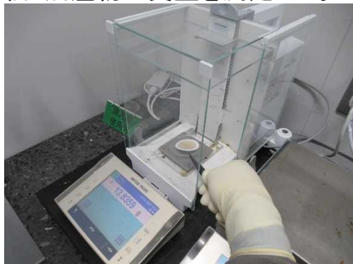
ろ紙+残渣物質量測定(試料ろ過後)
