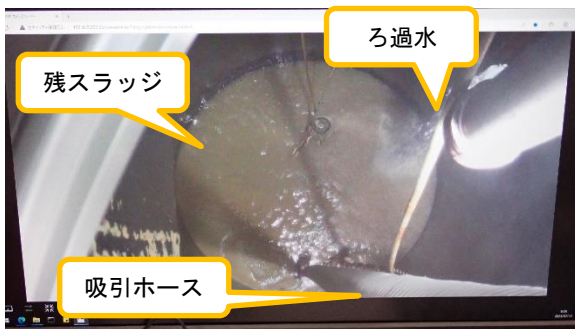
(写真2) 除染装置タンク内部の状況
