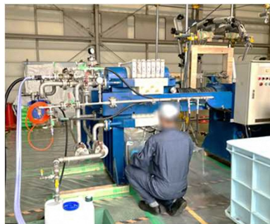
脱水処理(圧搾工程)
