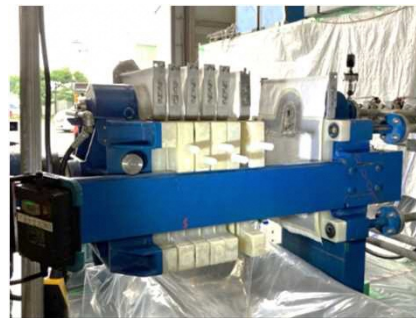
脱水処理(脱水物取出し工程)
