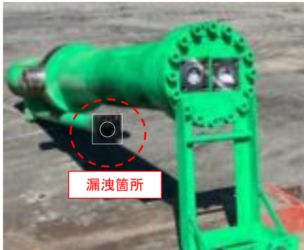
【作動油が漏洩した圧縮梱包機】
