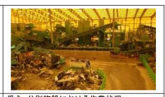
受入・分別施設における作業状況 ベルトコンベア等の動力部にはネットによる作業員の侵入防止措置が講じられていた。
