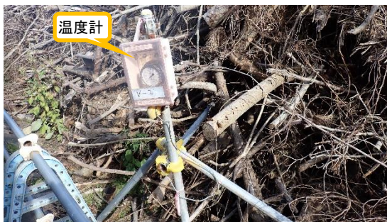
(写真 2 - 2) 伐採木内部の温度を把握するための 温度計の設置状況②
