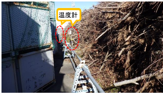
(写真 2 - 1) 伐採木内部の温度を把握するための 温度計の設置状況①
