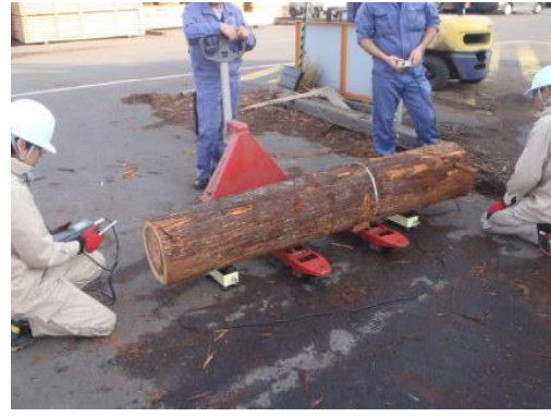
図-3 原木の Efr 測定状況
