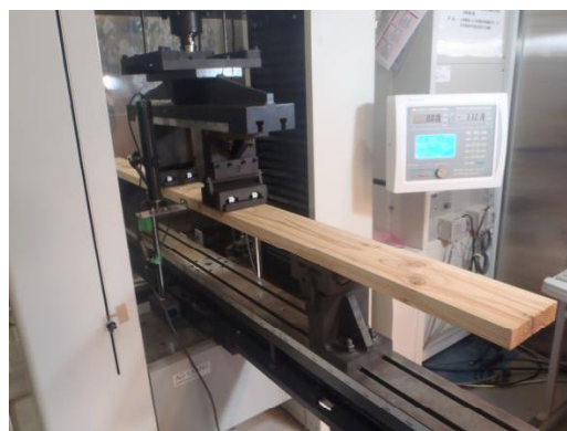
図-7 ラミナの曲げ試験状況
