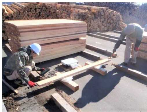
図-6 ラミナの Efr 測定状況
