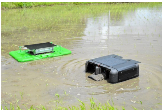
アイガモロボットによる除草作業
