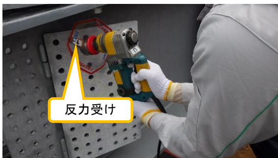
(写真 4 - 1) 電動トルクレンチの正しい使い方 ※反力受けに指が触れることはない
