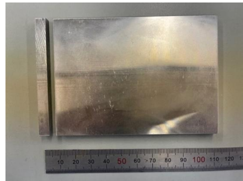
図6 平板供試体から採取した曲げ試験片の例
