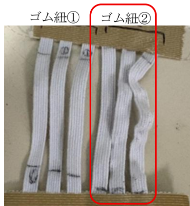
図5 個別デマッチャー試験後のゴム紐の様子
