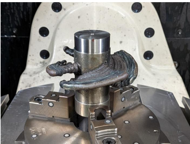
図 20 コバルト基合金積層造形後の形状
