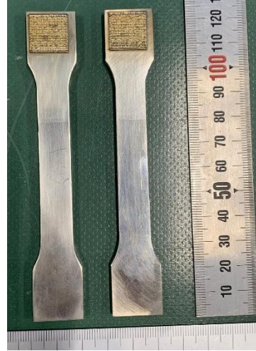
図5 つかみ部積層造形後の外観
