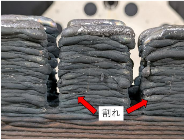
図2 割れ発生位置
