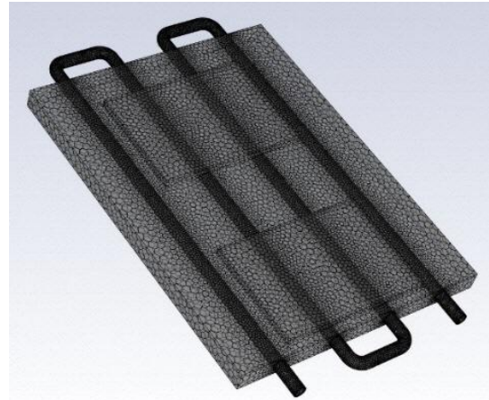
図13 水冷ヒートシンクの解析モデル
