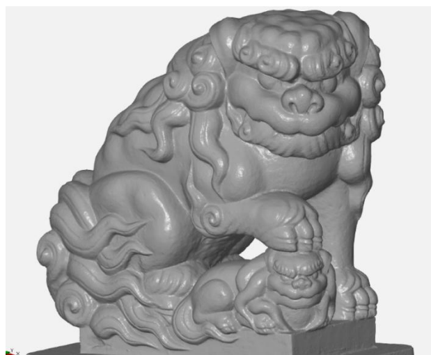
図 3 解像度 3,000 \times 2,000 の画像で作成した 3D データ
