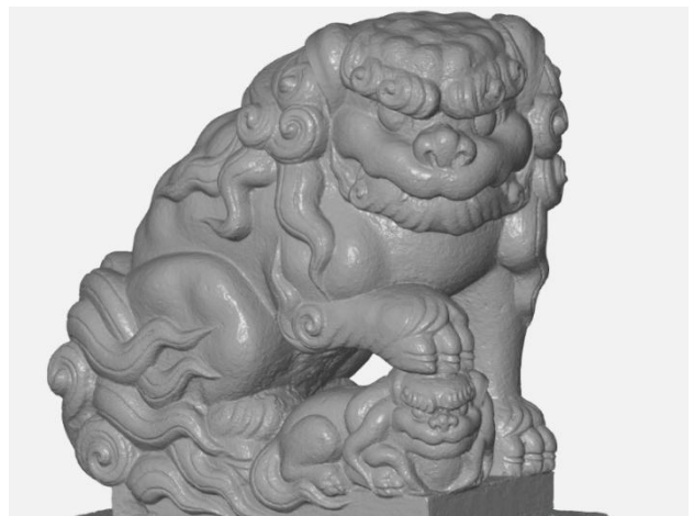
図6 解像度 6,000×4,000 の画像で作成した 3D データ (CPU 論理コア数 4、GPU 使用無し)
