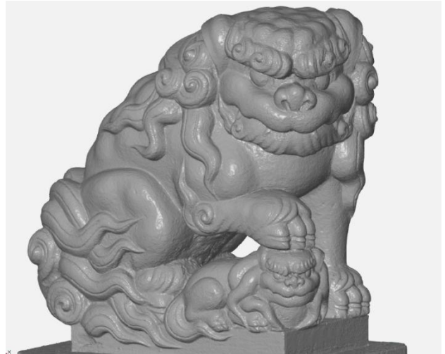
図5 解像度 6,000×4,000 の画像で作成した 3D データ (CPU 論理コア数 32、GPU 使用無し)
