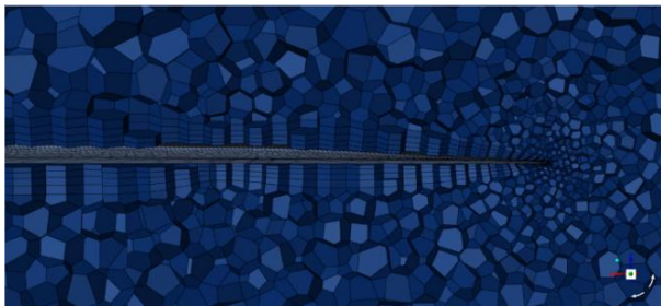
図7 ブレードと空気の境界拡大図(図5の白円部)
