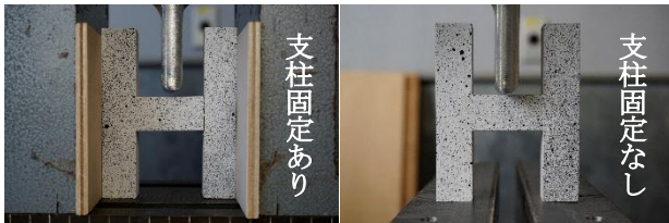
図3 H型試験の様子(L40[mm])
