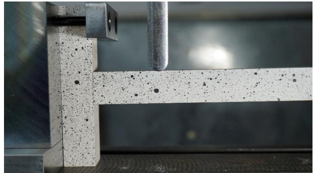
図5 T型試験の様子
