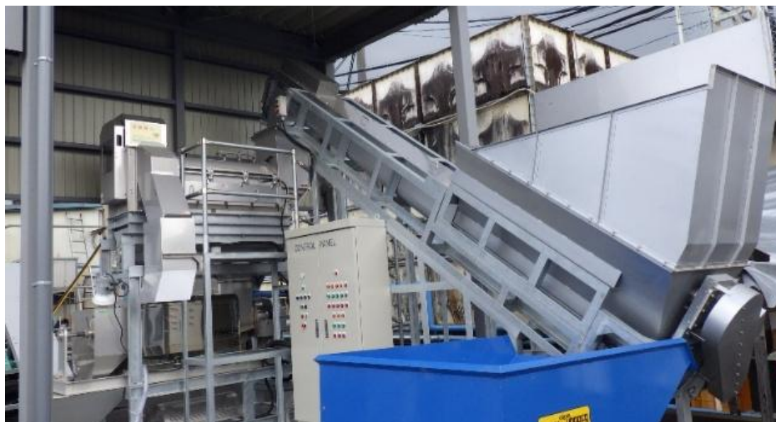
動植物性残さの脱水機（サンヨー缶詰株式会社）
