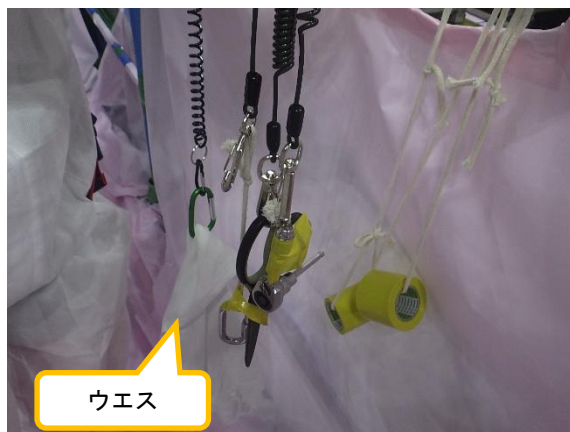
(写真2) 異物落下対策（落下防止紐の取り付け）の状況
