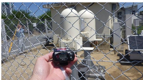
(写真6－1) モニタリングポスト No. 3における空間線量測定状況 ( 1.55 \mu\text{Sv/h} )
