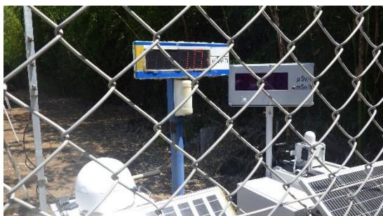
(写真6－3) モニタリングポスト No. 4における空間線量測定状況② (表示器では 1.0 \mu\text{Sv/h} )
