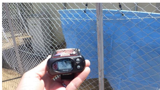
(写真6－2) モニタリングポスト No. 4における空間線量測定状況① ( 0.99 \mu\text{Sv/h} )
